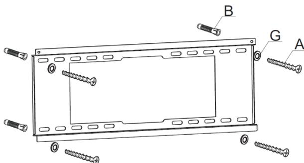
Usando un nivel de burbuja, asegúrese que la placa de pared esta nivelada, taladre dos agujeros con una broca de 10 mm y una profundidad de 50 mm. Coloque los tacos B y fije el soporte con los tornillos A. Coloque la arandela G para evitar movimientos y que el tornillo se desplace.
