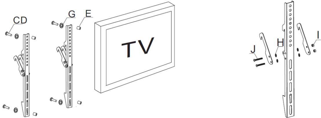
Fije las barras de sujeción a la televisión. Utilice los tornillos C o D (dependiendo de la métrica de su TV) para fijar la tv a su soporte. No olvide colocar entre el soporte y el tornillo la arancela tipo G finalmente, en caso de que sea necesario, con el tope de goma tipo E.
