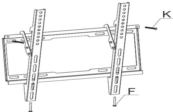
Utilice los Tornillos K y F para fijar las barras centrales a soporte y de esta manera evitar que se desplace o se descuelgue la televisión. Efectué una presión suave en cada tornillo hasta encontrar el punto idóneo de fijación. No fuerce en ningún caso el tornillo una vez haya llegado al tope.
