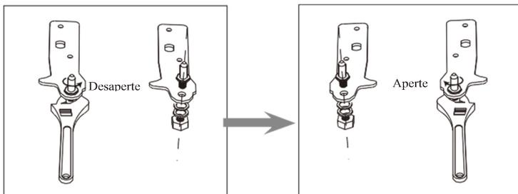
10. Retire o suporte que encaixa no pino da dobradiça inferior. Substitua os dois pés ajustáveis.
