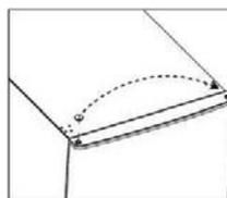
4. Desaparafuse a dobradiça inferior da porta livre. Em seguida, remova a porta e coloque-a em uma superfície macia para evitar riscos.
