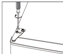
12. Coloque a tampa superior e fixe-a com 2 parafusos na parte traseira.
