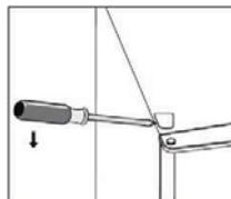
3. Mova a tampa do furo do lado esquerdo para o lado direito. A seguir, levante a porta superior e coloque-a numa superfície almofadada para evitar que se risque.
