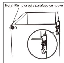
9. Desaparafuse e remova o pino da dobradiça inferior, vire o suporte e substitua-o.
