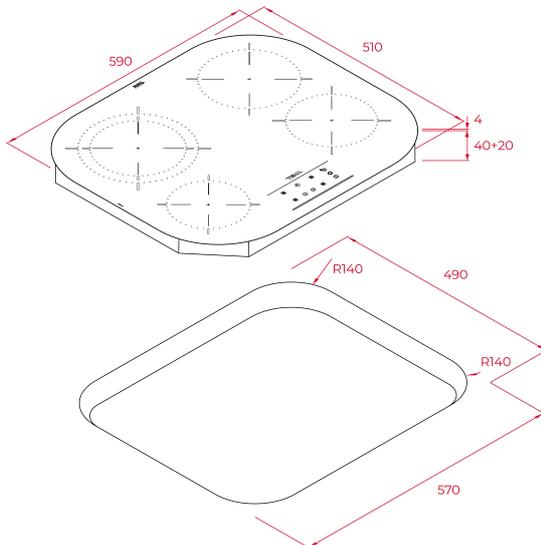
**DIMENSIONES****Altura del producto (mm): 51****Anchura del producto (mm): 590****Profundidad del producto (mm): 510****Longitud del producto (mm):****Peso neto (kg): 7,9****ESPECIFICACIONES TÉCNICAS**
